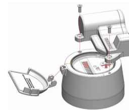
Рисунок 4. Встановлення модуля EDC-S на реєстратор у мідном корпусі (IP68)
